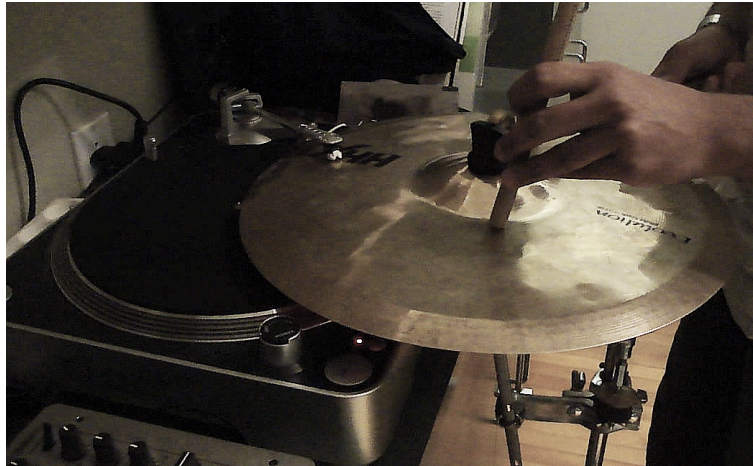
FIGURE 2.9: Expérimentation du couplage entre table tournante et cymbale.
