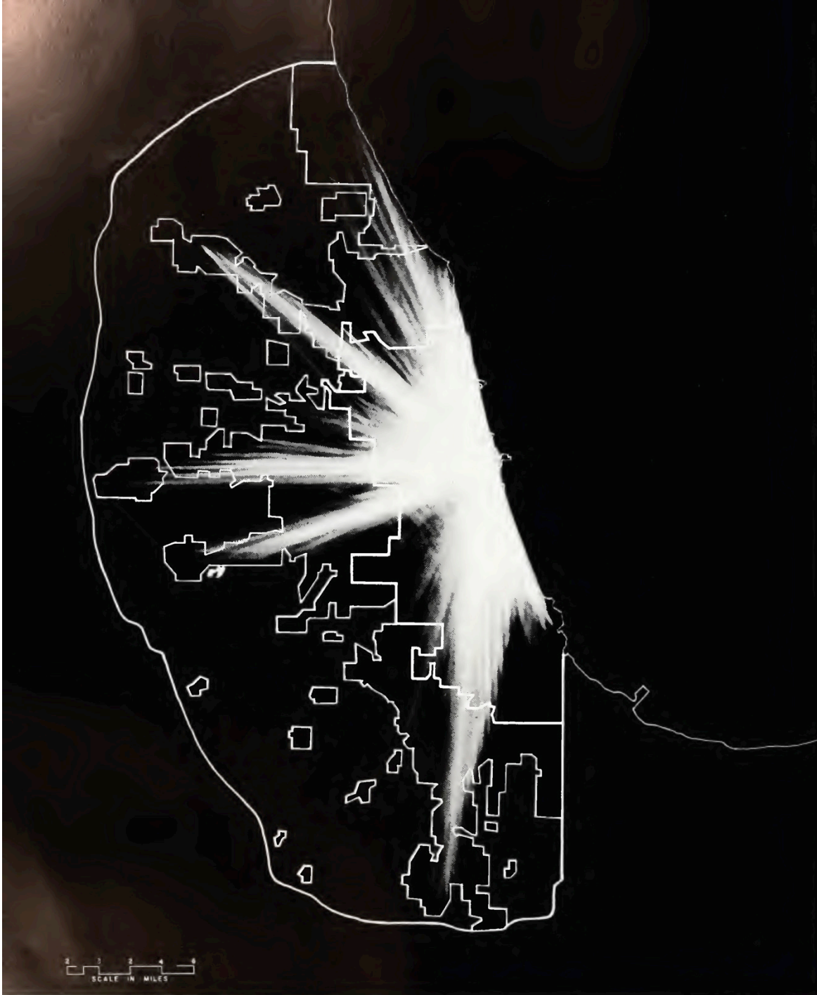
Figure 18. Cartographatron en tant que carte de lignes de désir , ou une somme des lignes reliant des origines à des destinations. Chicago Area Transportation Study , 40.
