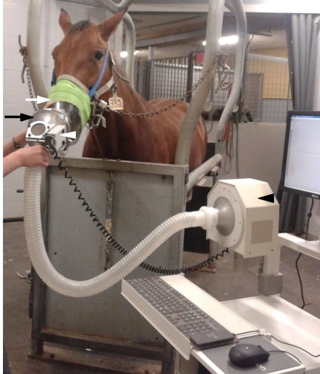
Figure 1.1. Composantes du système d'oscillométrie par impulsions. Haut-parleur (tête de flèche noire) relié par un tuyau flexible au pneumotachographe (flèche noire), lui-même connecté au masque (flèche blanche) porté par l'animal. En parallèle, le transducteur de pression (tête de flèche blanche) est connecté au haut-parleur et permet de mesurer les différences de pression et le débit d'air.
