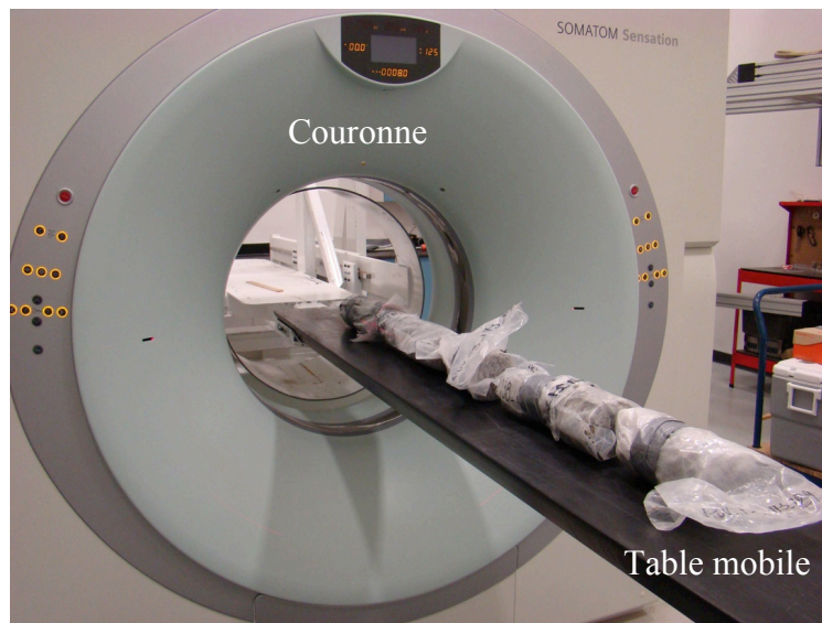
Figure 15. SOMATOM © Sensation 64 CT de la marque Siemens , situé à l'Institut national de la recherche scientifique (INRS) à Québec. La table noire traverse la couronne de capteurs.
