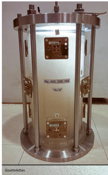
Figure 5.2 – Un détecteur Picasso. Une lumière a été ajoutée derrière le détecteur afin de montrer les gouttelettes de fréon dans le polymère d’acrylamide. Les dimensions sont au tableau 5.I. Un agrandissement du gel se retrouve dans la portion du bas de la figure.
