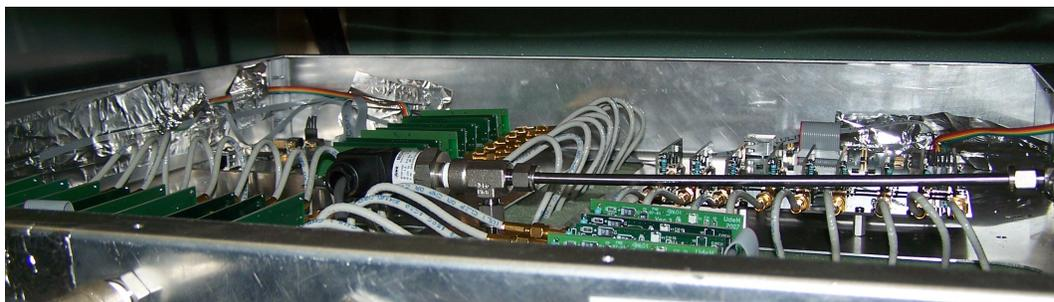
Figure 5.26 – Le compartiment supérieur du TPCS contient quatre ensembles de préamplificateurs, quatre cartes mères et quatre cartes DAQ pour les capteurs piézoélectriques des quatre détecteurs. De plus, un capteur de pression enregistre la pression dans les quatre détecteurs.
