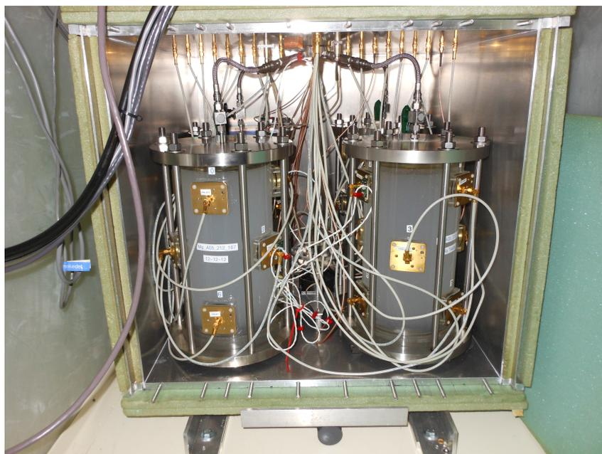
Figure 5.24 – Le TPCS Picasso peut contenir un maximum de quatre détecteurs. À l'aide de ses 15 capteurs de température et de ses huit résistances chauffantes, il permet de réguler la température des détecteurs avec une précision de  $\pm 0,1^{\circ}\text{C}$ .
