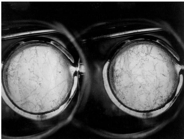
Figure 4.1 – Photographie de traces de particules dans une chambre à bulles à hydrogène. Crédit photo : Wikipedia
