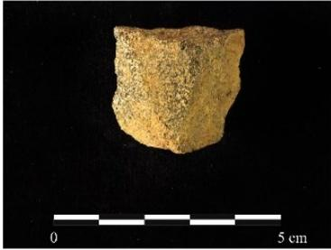
**Description macroscopique :** Roche poivre et sel holocristalline, phanéritique, massive à grains fins ( $d_m < 1\text{mm}$ ) équi-granulaires et subautomorphes. Plus de 40% de feldspaths blancs (plagioclases) et 50% de pyroxènes.
