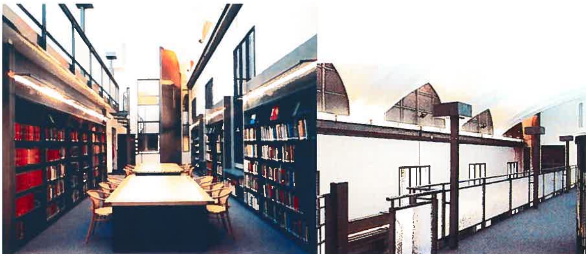
Figure 61 Vue de la bibliothèque, aménagée dans l'ancienne salle de bal dont le volume a été restauré par le retrait de la dalle qui l'avait séparé en 1967.
