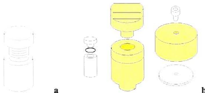
**Figure 25 : Présentation des contenants de synthèse ; (a) Contenant standard en téflon vissé et (b) contenant hermétique en laiton avec un compartiment en téflon pour synthèse à haute pression.**
