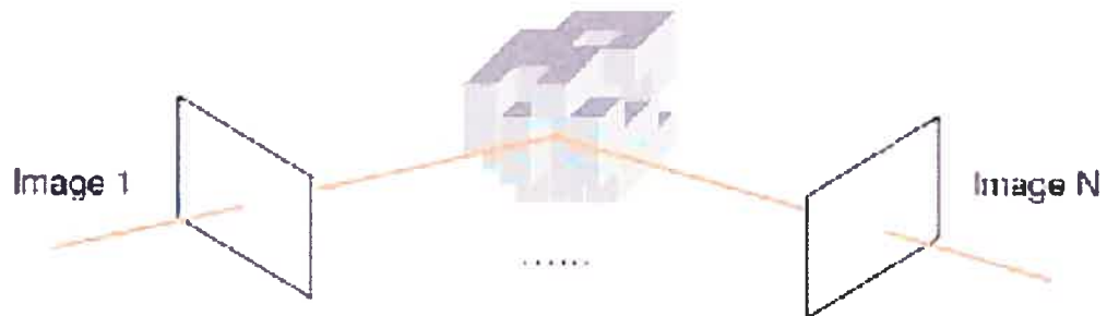
FIG. 2.7 – Schéma d'un volume que l'on "creuse" par la méthode du "space carving".
