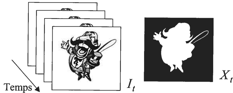
FIG. 4 – Illustration schématique du problème de la détection de mouvement. Partant d'une séquence vidéo I , l'objectif est d'estimer à chaque temps t , un champ d'étiquettes binaire X_t .
