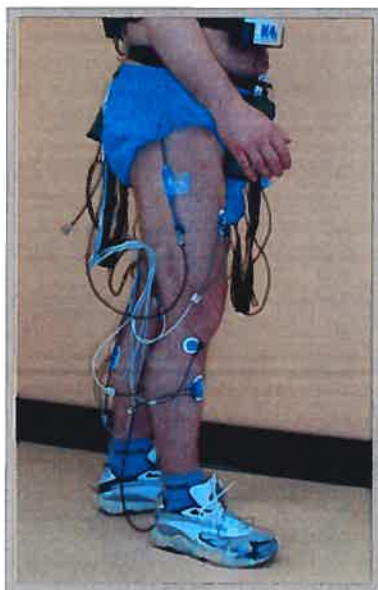
Figure 3.6 : Système d'acquisition des paramètres liés au patron de marche (signaux d'EMG et signaux d'électrogoniomètres).
