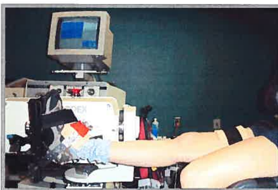
Figure 3.2 : Évaluation de la force musculaire maximale en flexion plantaire et en flexion dorsale à la cheville.
