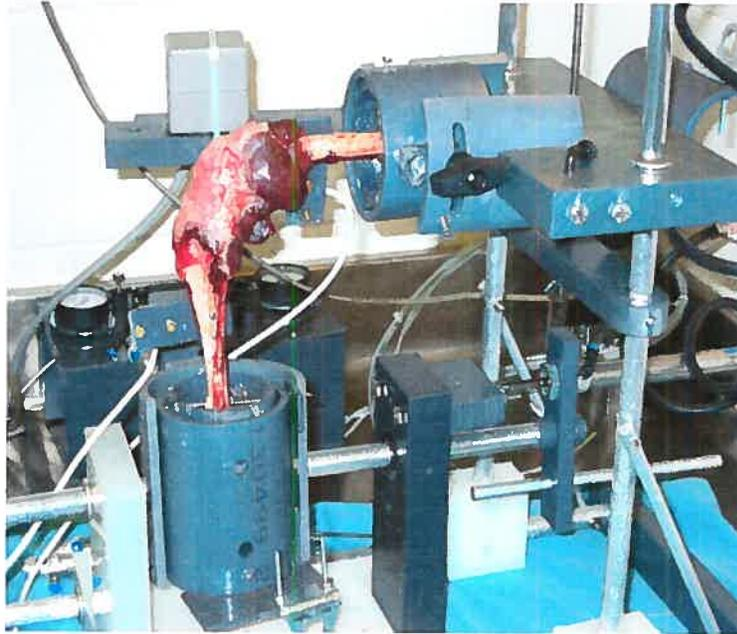
**Figure 7:** Montage Chevalier. Genou intact fixé à chaque extrémité dans un cylindre avec du PMMA et une vis.
