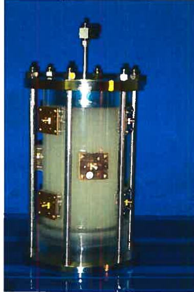
Figure 2.1 – Détecteur à gouttelettes surchauffées de l'expérience PICASSO de 4.5l dans un contenant d'acrylique. Le tube sur le dessus permet la recompression et les supports de couleur or permettent la connexion des câbles aux piézoélectriques
