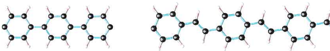
FIG. 3.1 – À gauche : polyparaphénylène (PPP). À droite : polyparaphénylène vinylène (PPV).
