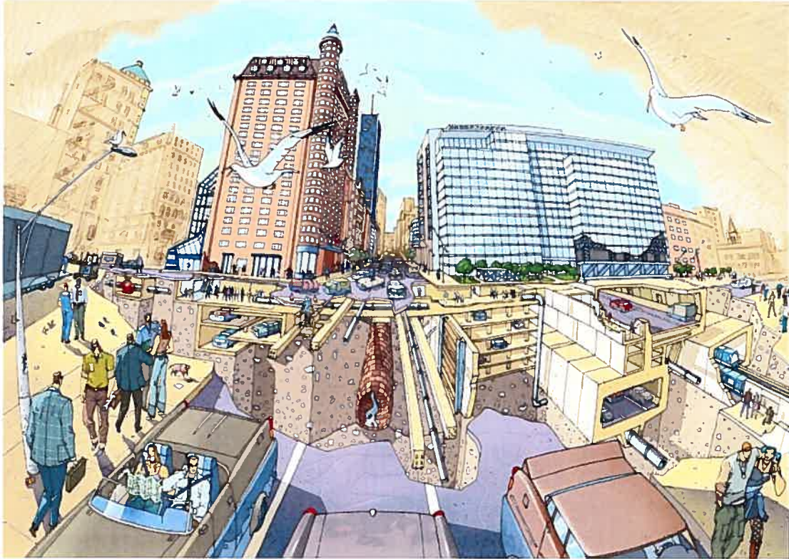
Figure 2 Entrecroisement des réseaux d'infrastructures dans le sous-sol de Montréal, 2003. Pierre Brignaud
