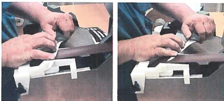
Figure 2.58 Technique de l'aiguisage avec le guide (option B)<sup>178</sup>
