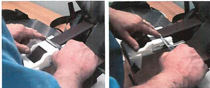
Figure 2.52 Technique de l'aiguisage avec le guide quatrième prototype.<sup>170</sup>
