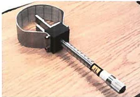
Figure 2.61 Système de rayon laser pour vérifier le fil du couteau.<sup>181</sup>
