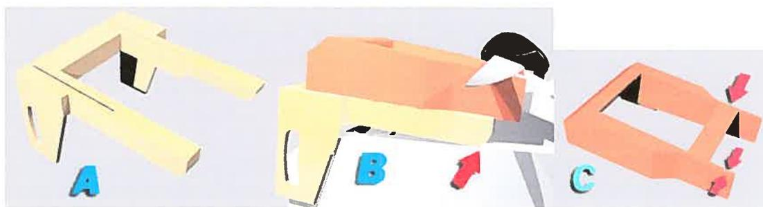
Figure 2.31 Troisième modèle, A- Dessins de la base B- L'axe de rotation C- Le support.<sup>143</sup>
