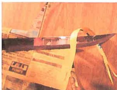
Figure 2.13 Technique pour vérifier le fil du couteau. <sup>121</sup>
