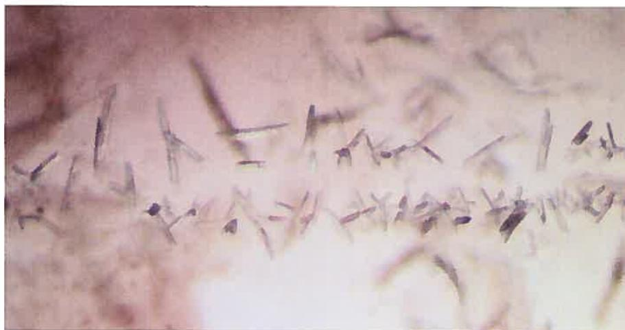
**Figure 6.10 :** Exemple de traînée de microcristaux obtenus par ensemencement.
