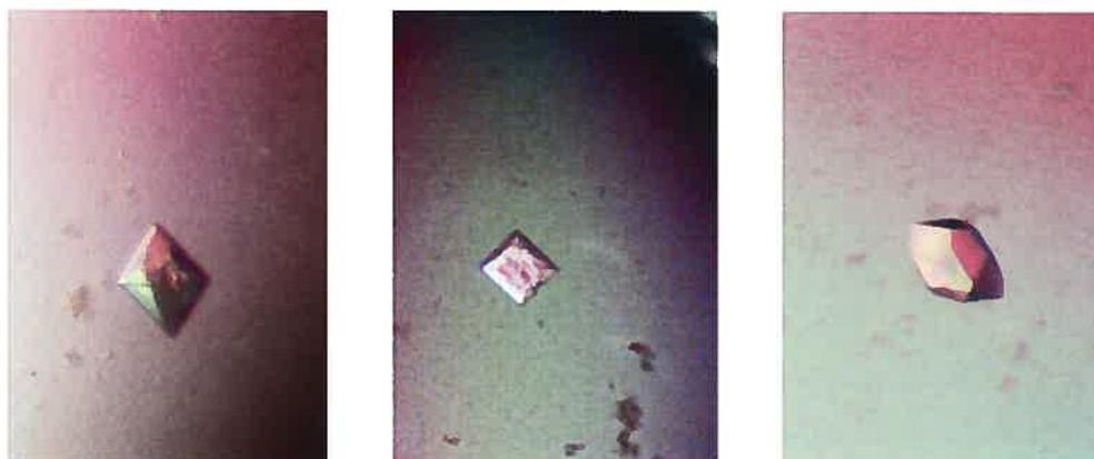
**Figure 6.11** : Meilleurs cristaux obtenus. 20% 2-methylpentane-2,5-diol (MPD), 0.1 M Tris pH 8.5, 25 mM MgCl<sub>2</sub>, 10mg/mL TGase. 0.6 M CaCl<sub>2</sub>. La taille des cristaux est d'environ 0,1 mm sur les trois axes.
