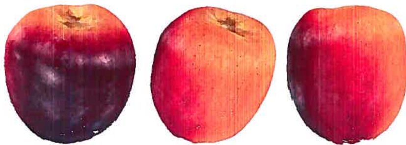
FIG. 6.9 – Pomme en plastique reconstruite à l'aide du piédestal automatique et d'un miroir en un seul tour complet. Temps total de reconstruction : 5 minutes ; temps total de post-traitement : 2 minutes ; définition : 50,000 points.
