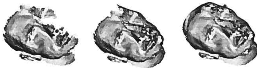
FIG. 6.2 – Reconstruction statique de la tête : tous les éléments du système de reconstruction restent fixes, seul le nombre de miroirs utilisés change. Gauche : aucun miroir. Centre : un miroir ; Droite : trois miroirs.
