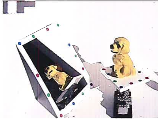
FIG. 6.8 – Image de la caméra illustrant les conditions de reconstruction lors de l'utilisation du miroir avec le piédestal automatique. On peut observer que la caméra a une vue en plongée sur l'objet pour permettre le suivi précis des marqueurs de couleur du piédestal. Le miroir est placé pour offrir une vue en contre-plongée.
