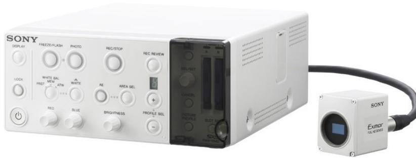
Figure 40 : Système de caméra numérique pour microscope opératoire [26]
