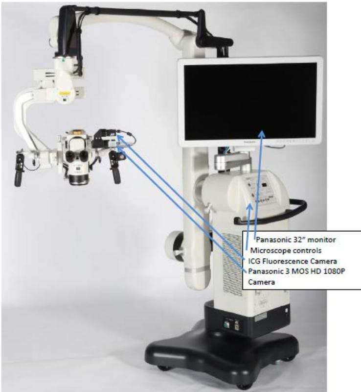
Figure 39 : Moniteur de visualisation pour microscope opératoire [31]
