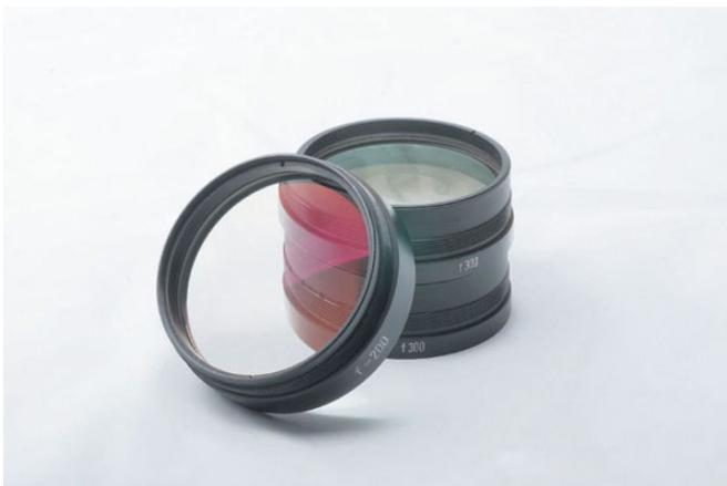
Figure 13 : Objectifs de microscopes opératoires de focale 200mm et 300mm [23]
