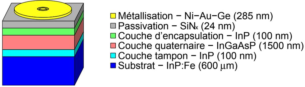
FIGURE 2.3 – Structure d’un échantillon après fabrication de la structure MIS. Une couche diélectrique  $\text{SiN}_x$  de 24 nm est déposée par LF-PECVD sur la structure déjà présentée à la Figure 2.1. Par la suite, un masque de photolithographie est utilisé pour le dépôt d’une couche de métallisation de 285 nm.
