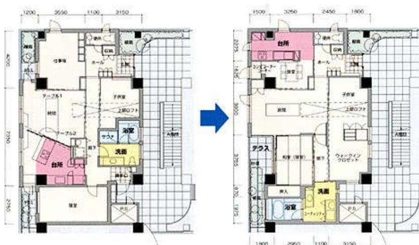
Figure 19 : Plans d'étage montrant les possibilités de changements d'un même logement dans le bâtiment NEXT 21. (Source : [http://www.mech.hku.hk/sbe/case\\_study/case/jap/next21/next21-as.html](http://www.mech.hku.hk/sbe/case_study/case/jap/next21/next21-as.html))
