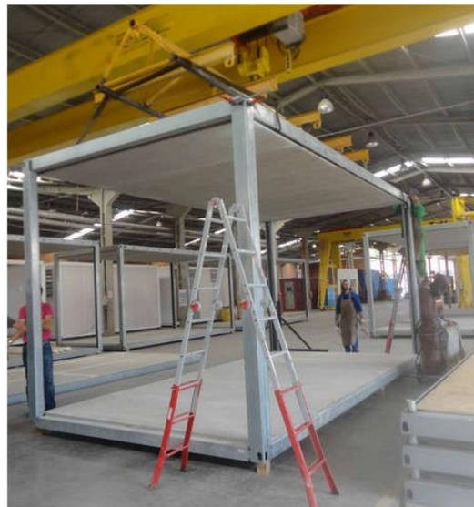
Figure 16 : Module 3D de l'entreprise Siscobras. (Source : <http://www.ufrgs.br/eso/content/?p=1296>)
