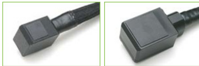
Figure 12. Thermode TSA-II, Medoc, Haifa, Israel de 2,56 \text{ cm}^2 (à gauche) et de 9,00 \text{ cm}^2 (à droite). Reproduit à partir du site web du manufacturier.
