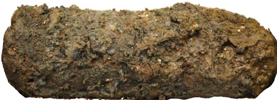
Figure 10. 11 – Carotte de diamicton silteux. Elle a été récoltée du forage YG1\_1 (1050-1076 cm). Noter la cryostructure interstitielle invisible, l'apparence d'une certaine quantité de matière organique du côté gauche et un certain niveau d'oxydation du côté droit (partie basse de la carotte). Photo : Stephani (2013).
