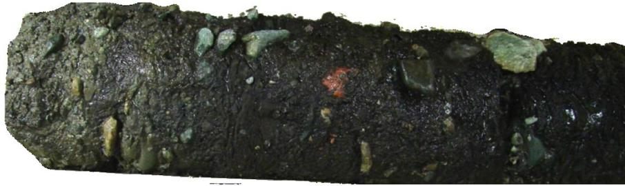
Figure 10. 10 – Carotte de diamicton tourbeux. Elle a été récoltée du forage YG2181 (797-832 cm). Noter la cryostructure interstitielle invisible à microlenticulaire du côté gauche et au centre et lenticulaire du côté droit (partie basse de la carotte). Photo : Stephani (2013).
