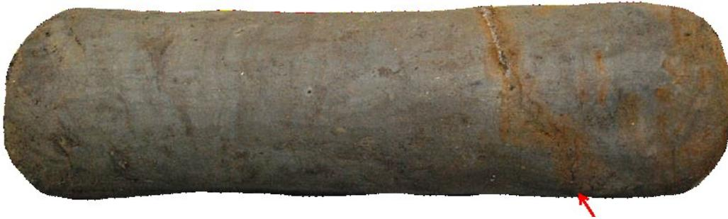
Figure 10. 6 – Carotte de silt massif incluant un plan de faille oxydé (flèche rouge). Elle a été récoltée du forage YG5-1 (244-279 cm). Photo : Stephani (2013).
