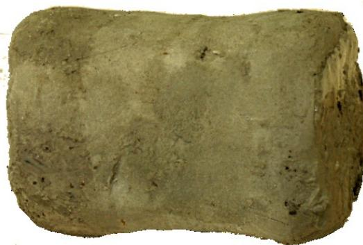
Figure 11. 1 – Carotte de silt massif avec une cryostructure interstitielle invisible. La glace est invisible à l’œil nu et ne se trouve que dans la microporosité. Elle provient de Top3 (66-77 cm)
