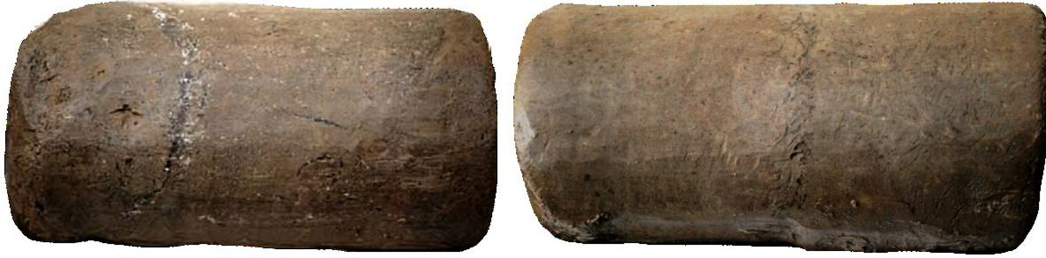
Figure 11. 9 – Carottes de silt tourbeux incluant une lentille de glace singulière (partie de gauche, haut) et une bande de microlentilles (milieu de la partie de droite, bas). Elles proviennent respectivement des forages YG2-1 (470 cm) et YG2-2 (495 cm). Photos: Stephani (2013).
