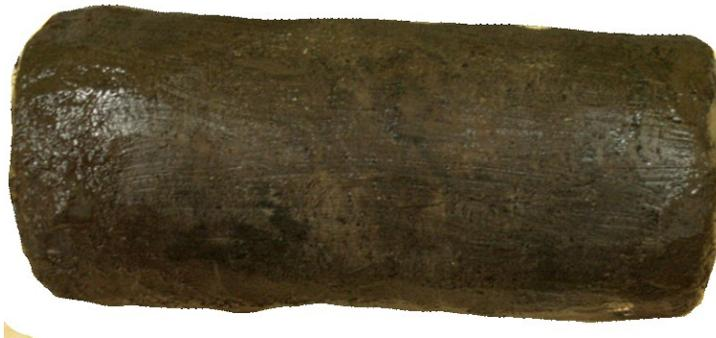
Figure 10. 3 – Carotte de tourbe silteuse. Elle a été récoltée du forage BH12-1005 (83-103 cm) et son contenu organique a été mesuré à 35 %. Noter sa cryostructure interstitielle invisible au centre à interstitielle visible vers les extrémités.
