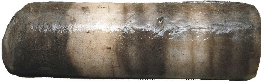
Figure 11. 7 – Carotte de glace massive stratifiée horizontalement incluant des nuages de bulles aplaties sur le plan horizontal. Elle provient d'YG4-3 (110-140 cm). Photo: Stephani (2013).
