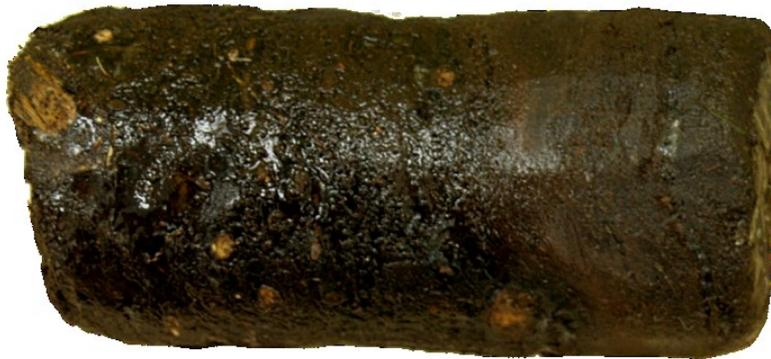
Figure 11. 3 – Carotte de tourbe silteuse avec la cryostructure typique de la matrice organique, La partie de gauche (haut) est caractérisée par une cryostructure interstitielle visible et celle de droite, par une cryostructure microlenticulaire. La carotte provient de BH12-1005(20-34 cm).
