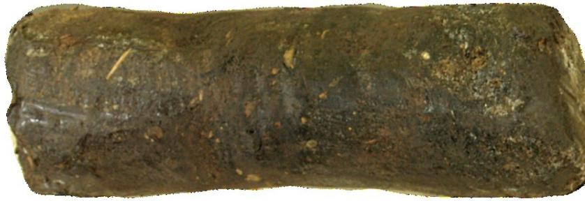
Figure 10. 2 – Carotte de tourbe mésique. Elle a été récoltée au bas du forage S0 (20-25 cm) et son contenu organique a été mesuré à 64 %. Noter sa cryostructure interstitielle invisible à gauche et au centre et interstitielle visible à droite.
