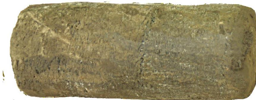
Figure 11. 5 – Carotte de silt massif avec une cryostructure microlenticulaire (la glace apparaît en noir) et une bande de microlentilles. Elle provient de BH12-997 (75-90 cm).
