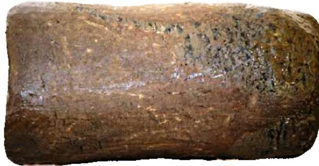
Figure 10. 7 – Carotte de silt et tourbe désordonnés. Elle a été récoltée du forage YG1-1 (529-546 cm). Noter que la saturation de la couleur a été augmentée afin de différencier la tourbe du silt. Noter la cryostructure stratifiée-lenticulaire dans le silt et la cryostructure interstitielle invisible dans la tourbe. Photo : Stephani (2013).
