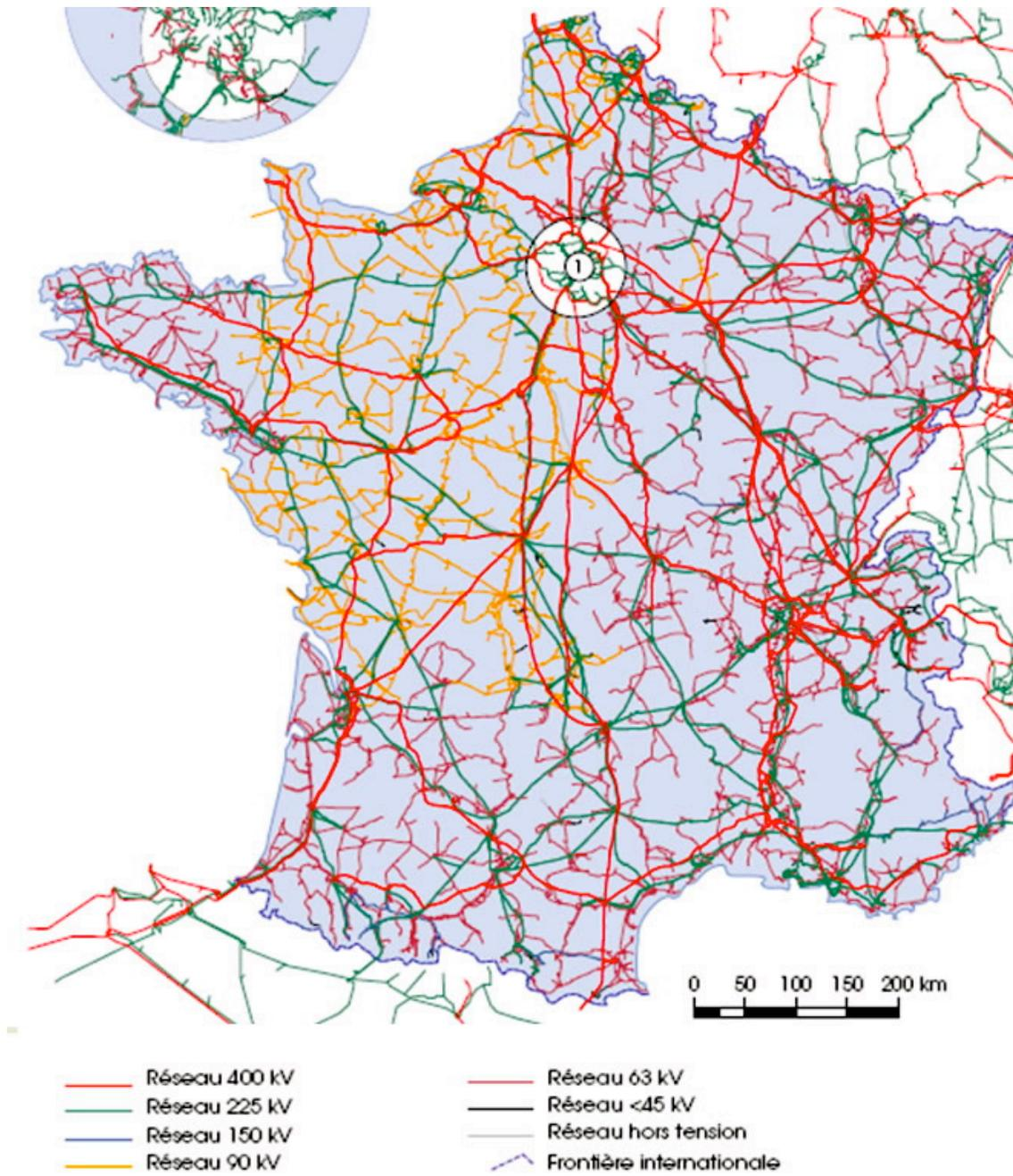
Figure 6 : Réseau de transport français en 2012 (400 kV, 225 kV, 150 kV, 90 kV, 63 kV)<sup>27</sup> :
