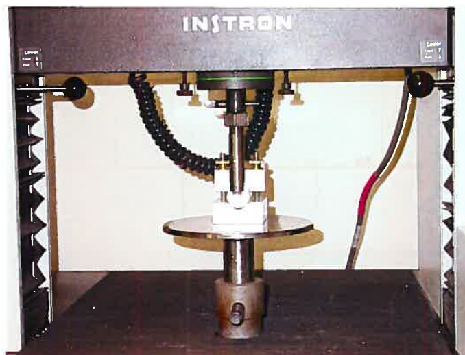
Figure 4.9 : Spécimen positionné dans le Test Base Clamp (Ultradent Product, University Department) et placé sur la plateforme de l'appareil Instron.
