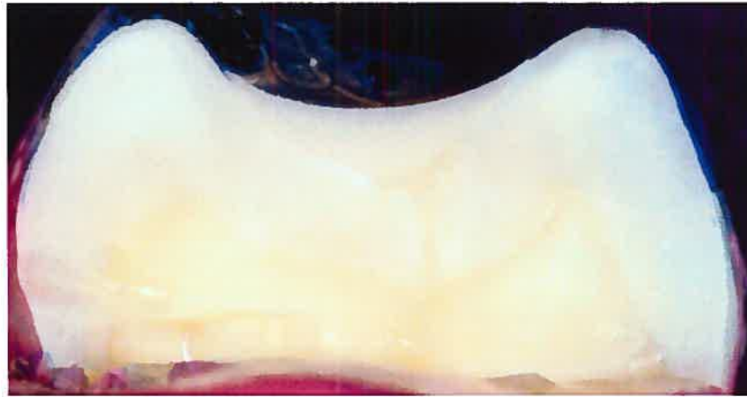
Figure 5.2 : Photographie d'un spécimen ayant obtenu un grade 0 d'infiltration - Aucune pénétration du colorant.
