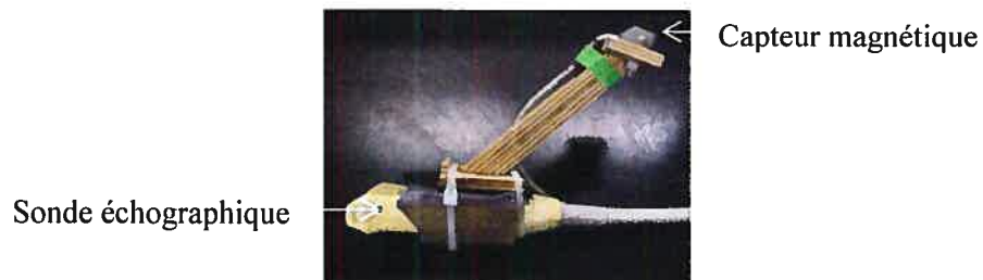
Figure 2.1 - Capteur de localisation fixé sur une sonde échographique (dispositif utilisé dans ce projet).
