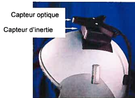
Figure 2.7 - Exemple de système de localisation hybride : le Hy-Bird d'Ascension Technology.
