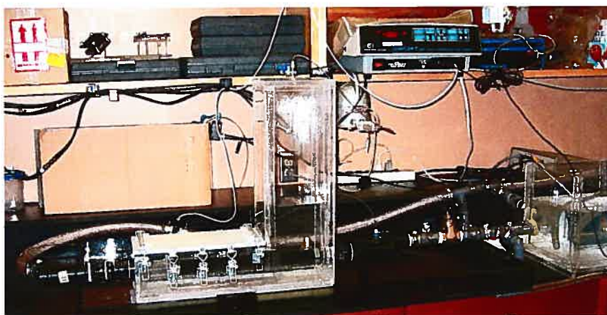
FIG. 5.3 – Boîtier de plexiglas contenant la chambre à air faisant office d'aorte. Il constitue la compliance aortique
