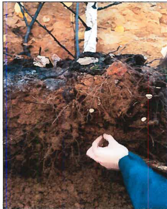
Figure 2.2. a) Technique d'échantillonnage des arbres sélectionnés; b) Horizons organiques et minéraux d'un podzol; c) Prélèvement des racines et de la matrice de sol dans l'horizon B sous un bouleau blanc au site 1.
