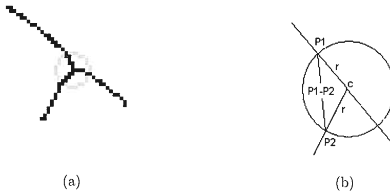
FIG. 3.3. Point d'intersection pour calculer les angles de la structure. (a) Intersection du cercle avec la bifurcation en trois points. (b) Triangle formé par deux points de l'intersection et le centre pour le calcul de l'angle formé par les branches de la bifurcation.
