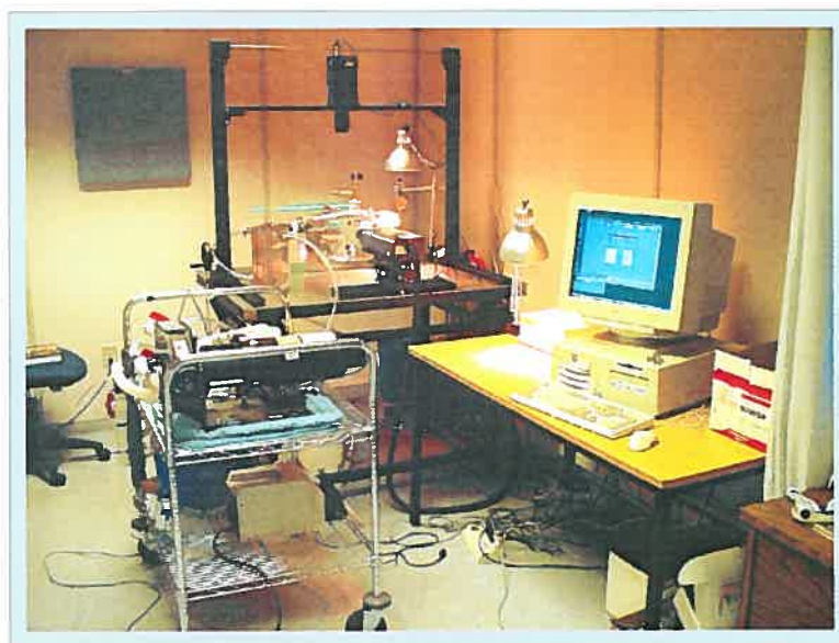
Figure 6-10 : Installation complète PIV
