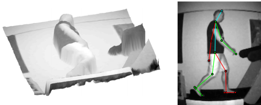
Figure 2.14 – Calcul du squelette à partir de la carte de profondeur de la Kinect [48].
