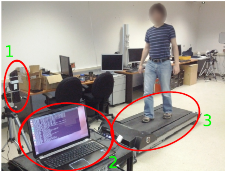
Figure 4.1 – Photo illustrant le montage d'acquisition des données : la caméra de profondeur (1), l'ordinateur permettant l'enregistrement des cartes de profondeur (2) et le tapis roulant (3) [8].
