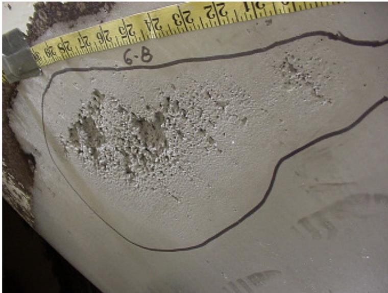
(b) Exemple d'érosion de cavitation sur une aube
