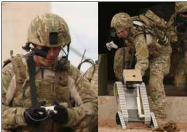
**Soldats américains utilisant un contrôleur Xbox pour le pilotage d'un robot télécommandé**
