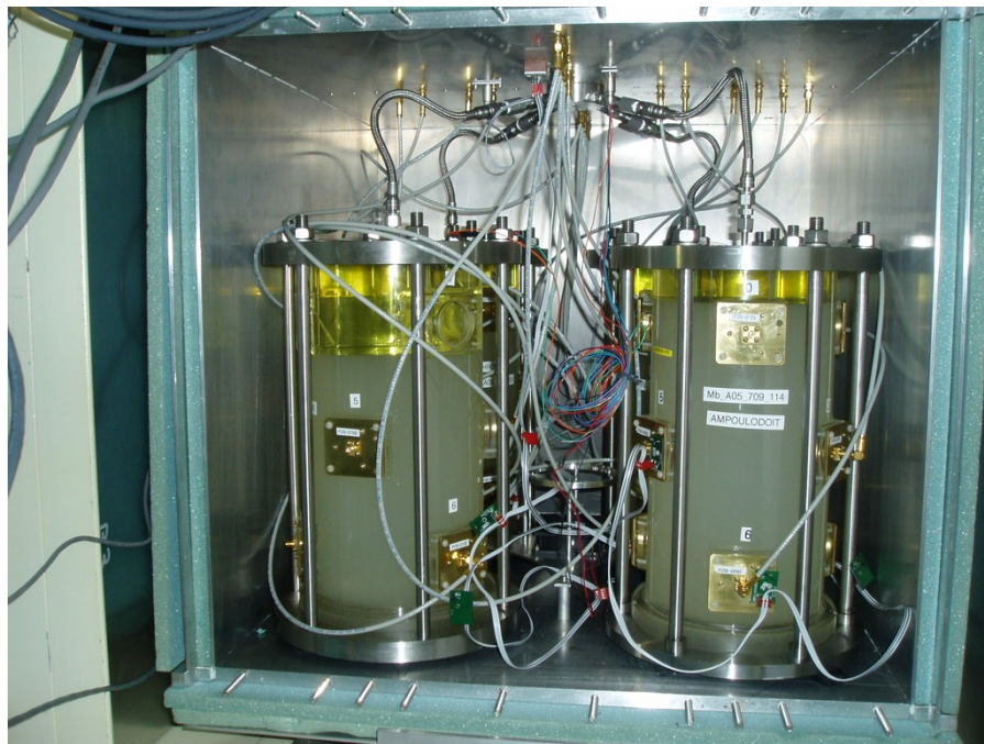
Figure 5.9 – Un des 8 systèmes de contrôle de pression et température de l'expérience PICASSO installé dans le laboratoire Snolab (TPCS). Chaque TPCS contient quatre détecteurs.
