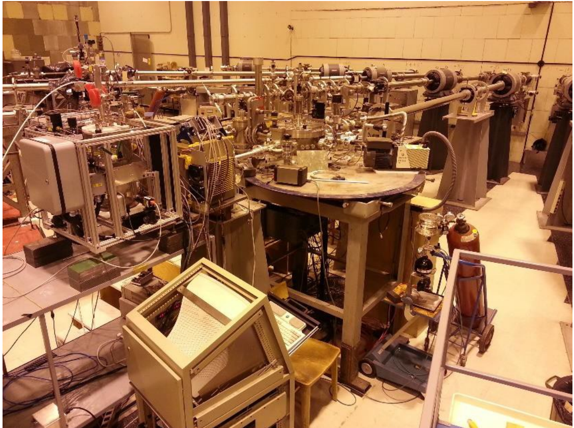
Figure 6.5 – Ligne du faisceau de protons de l'accélérateur de type van de Graaff pelletron situé à l'Université de Montréal.
