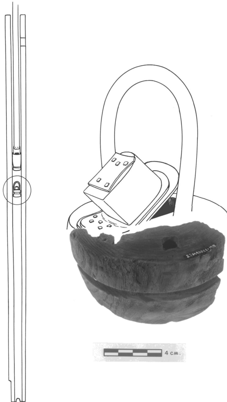
Figure 22. Chopine ou clapet de pompe en bois (Photo: R. Chan, Parcs Canada RA17315B. Dessin: C. Piper, Parcs Canada 22m-90-103-2)
