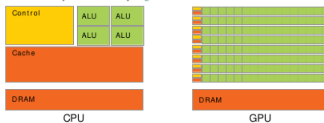
Figure 5.5 – Schéma montrant la densité des transistors destinés aux calculs et ceux dédiés aux contrôles de flux dans les GPU et les CPU. Source : Nvidia [151].
