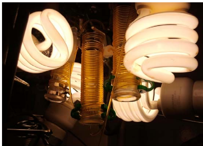
Figure 35. Montage expérimental de la synthèse du [5]hélécène ( 78 ) en flux continu
