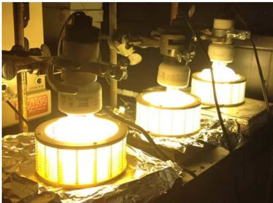
Figure 51. Zoom sur la disposition des lampes dans les réacteurs
