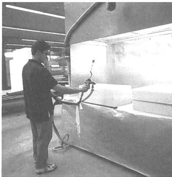
Figure 4.5 - Collage de blocs de mousse de polyuréthane (avec l'aimable autorisation de la société Domfoam International, Montréal).
