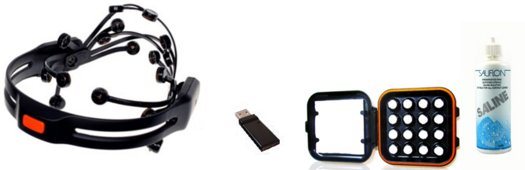
Figure 5.2 – Dispositif EEG Emotiv Epoc utilisé. De gauche à droite : le casque EEG sans fil, le récepteur USB et le kit d'hydratation des senseurs. 2
