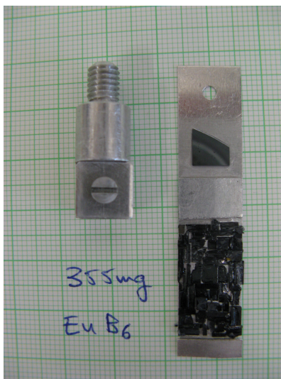
Figure 2.12 – échantillon en mosaïque de \text{EuB}_6 utilisé à PSI et l'ILL tel qu'aligné par S. Gerber.
