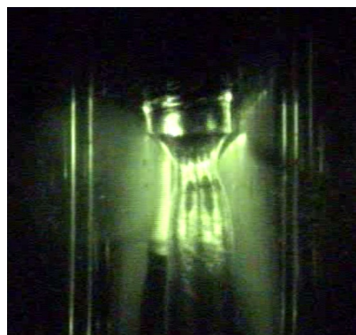
(a) Croissance du \text{LaRhSi}_3 dans la fournaise optique du laboratoire de Prof. Balakrishnan. On remarque un étalement très long de la zone de chauffage étant donné la haute conductivité thermique du métal.
