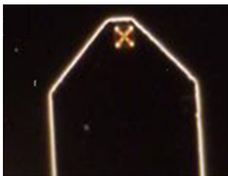
Figure 4.5 Image caméra du levier AFM en microscopie en champ sombre.
