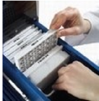
Figure 1.13 Insertion de plaques LDTD dans l'échantillonneur. Ce dernier peut contenir jusqu'à 10 plaques, pour un total possible de 960 analyses par séquence analytique
