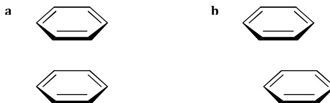
Figure 12. Illustration de l'orientation parallèle entre deux molécules de benzène lors d'un empilement de type \pi \cdots \pi . (a) Alignement parfait. (b) Alignement décalé.
