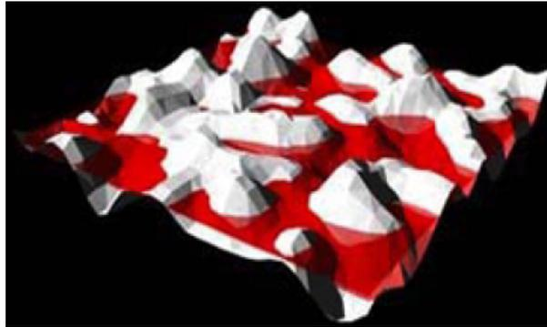
Figure 2.11 – Échantillon de micro-géométrie dans Westin et al. [67] avec le plan moyen indiqué en rouge semi-transparent.
