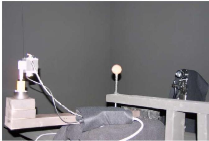
Figure 2.8 – Système de mesure de la BRDF de Matusik et al. [36].
