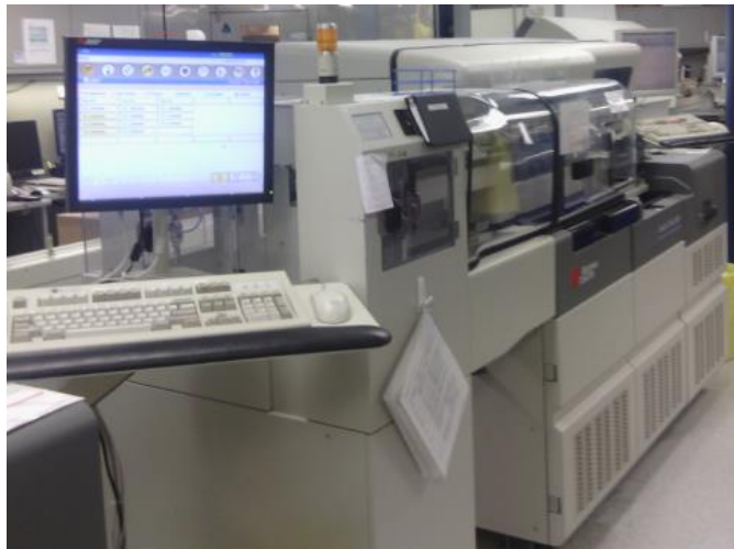
Figure 4: Équipement d'analyseur d'immunologie automatisé à l'HGL.
