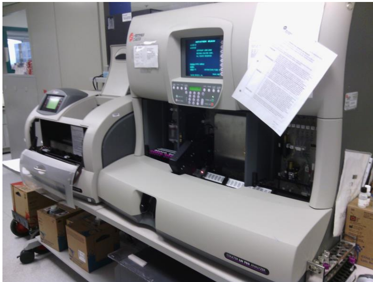
Figure 5 : Analyseur d'hématologie automatisé
