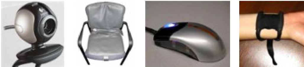
Figure 3.6 – Senseurs physiques utilisés par Arroyo et al. (2009a) pour la reconnaissance des émotions. De gauche à droite : caméra de détection des expressions faciales, siège détecteur de posture, souris équipée de senseurs de pression, et bracelet capteur de la conductivité de la peau.
