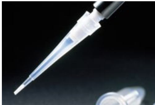
Figure 3.14. Photo d'un embout de pipette de type OMIX de 20 \mu\text{L} de volume contenant une phase stationnaire C_{18} présente dans les 5 premiers millimètres de l'embout.
