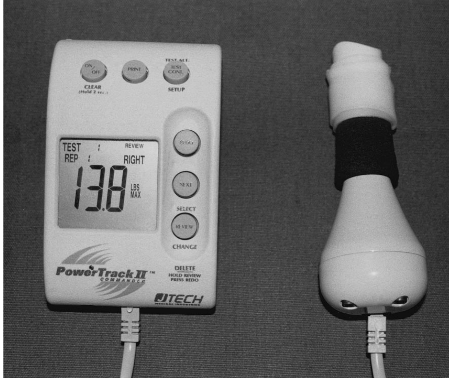
Figure 12: Dynamomètre manuelle (Digitrack) et dispositif portable de stockage de données informatisées (Commander Power Track II)
