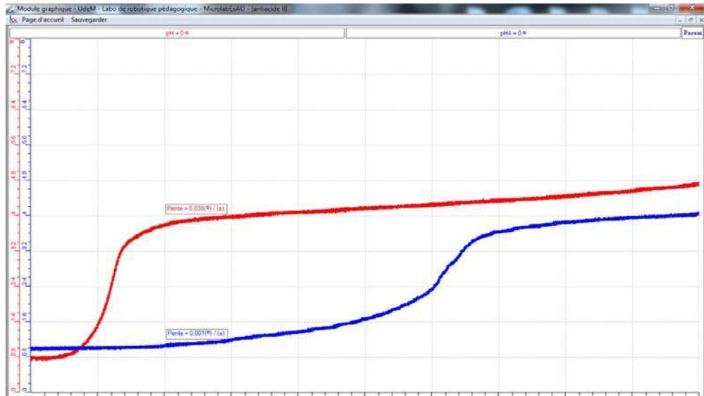
La courbe en bleu est la neutralisation avec le Maloxe en comprimé
