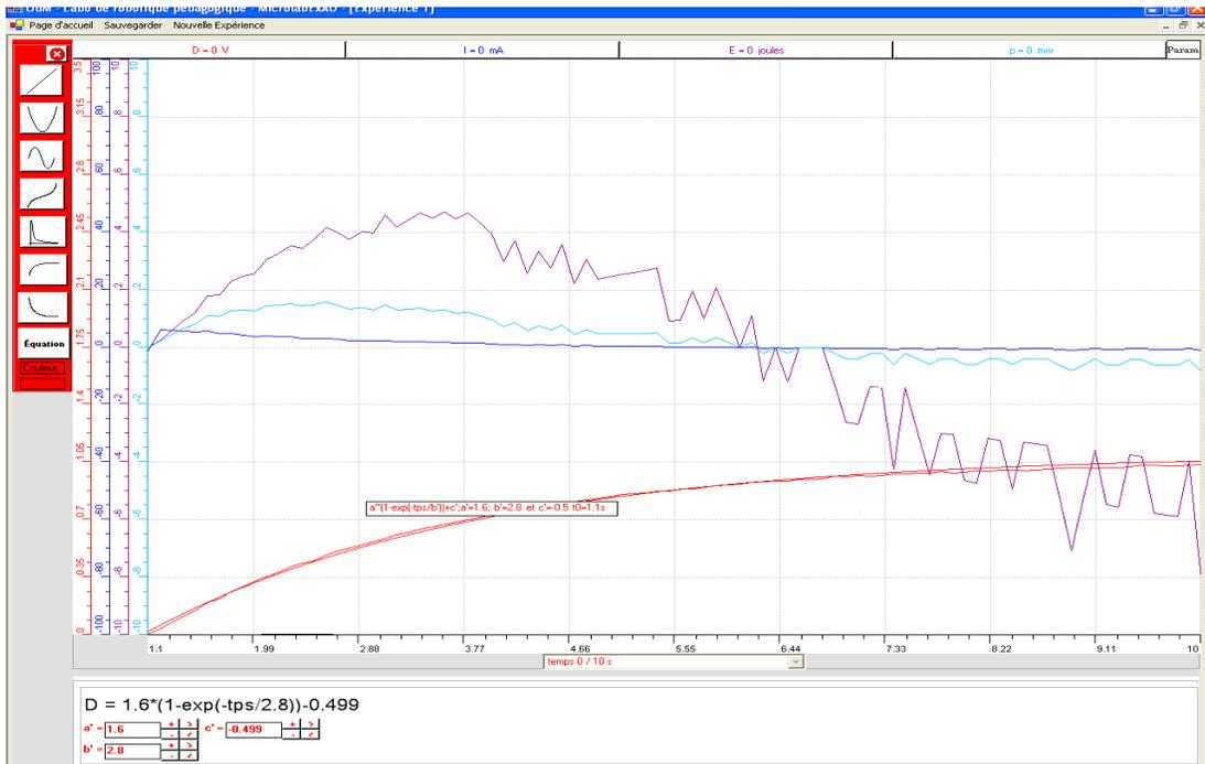
La tension est la courbe rouge, l'intensité amplifiée est en cyan, la puissance est en bleu et l'énergie est en violet.
