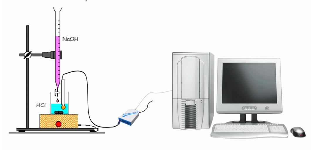
Figure 24 : Montage expérimental du dosage d'un acide par une base
