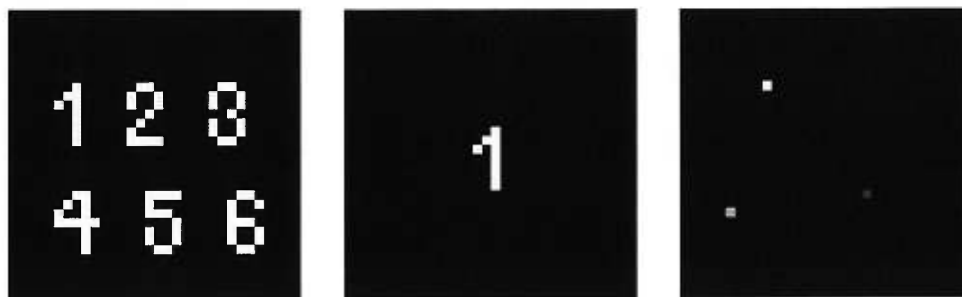
FIG. 5.1 – Image de gauche: Image originale. Image de centre: Image à ajuster. Image de droite: Résultat de la corrélation entre une l'image originale et l'image à ajuster dans le domaine des fréquences
